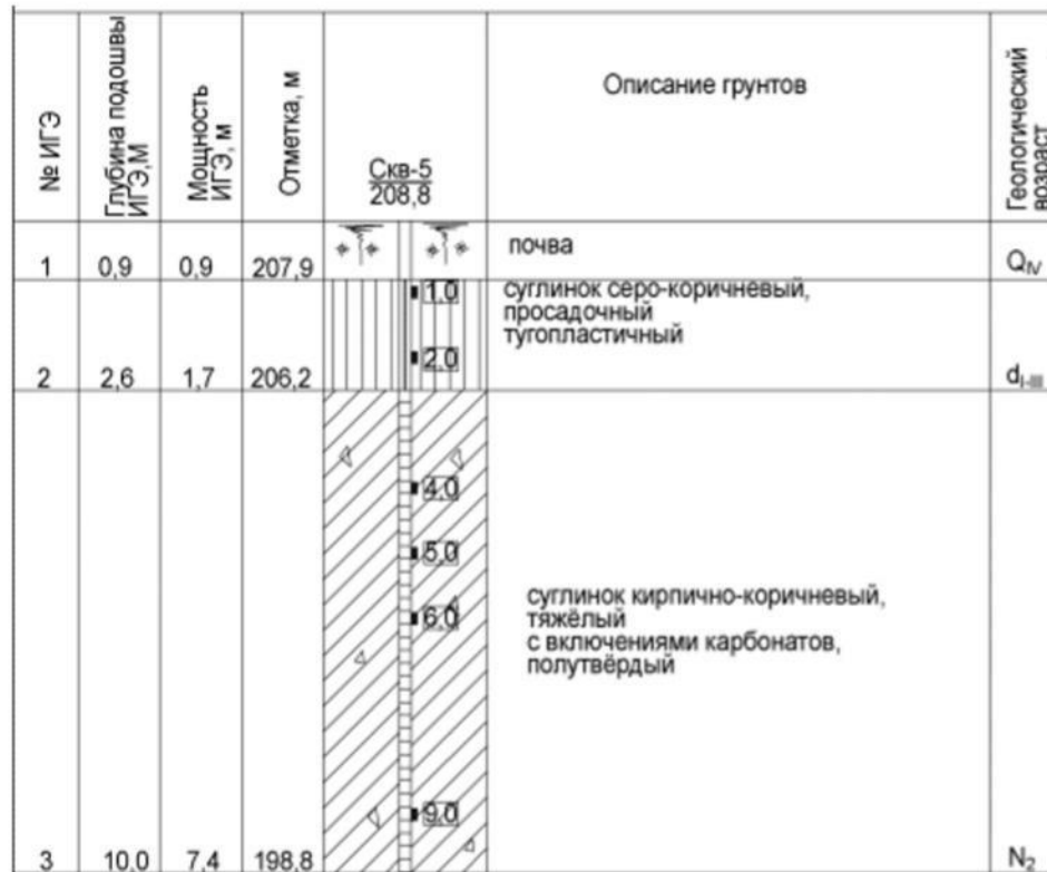
Рисунок 4.1 – Геологический разрез и конструкция скважины
