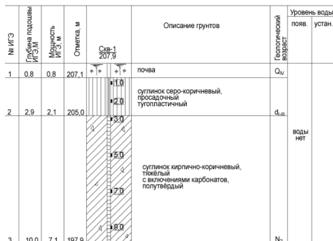
Рисунок 2.2 — Инженерно-геологическая колонка участка строительства
