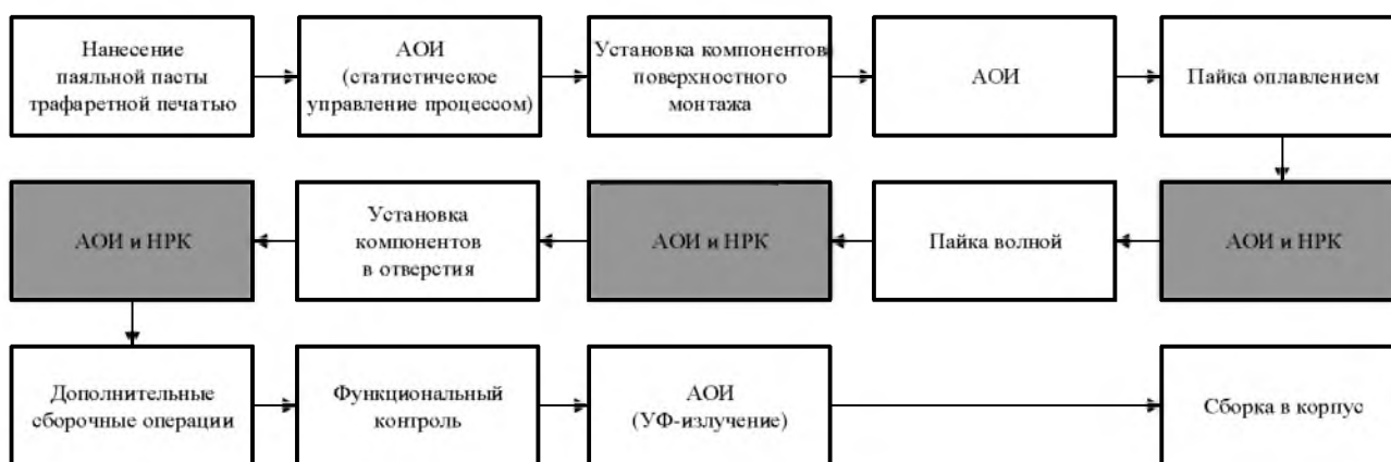
Рис. 1. Технологическая схема сборки электронного модуля Fig. 1. Technological assembly scheme of the electronic module
