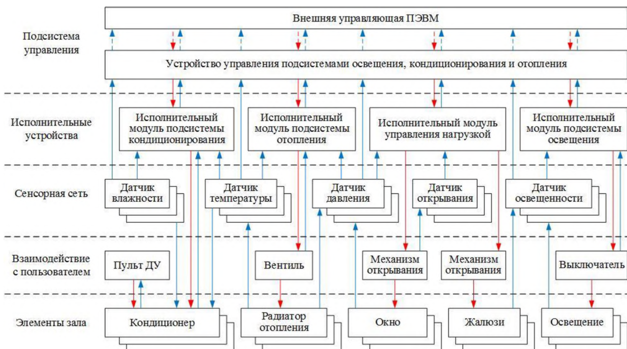
Рис. 2. Взаимосвязь подсистем жизнеобеспечения интеллектуального зала совещаний Fig. 2. Interconnection of the life support subsystems of meetings smart hall
