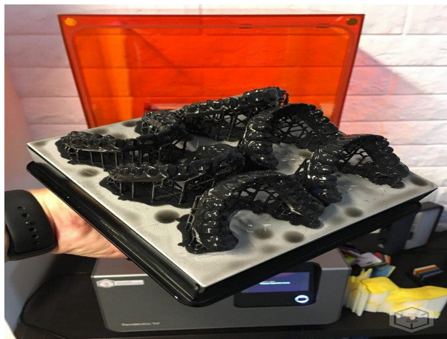
Рис.18. Распечатанные элайнеры на 3-D принтере из фотополимерной СМОЛЫ
