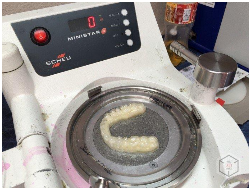
Рис.19. Изготовление элайнеров в вакуумформере
