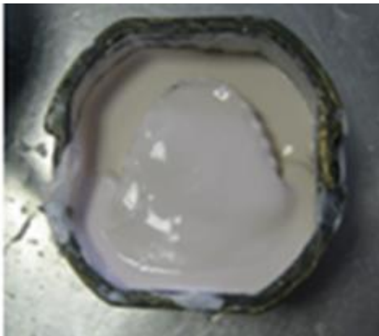
Рис.11. Заполнение врой части кюветы гипсом
