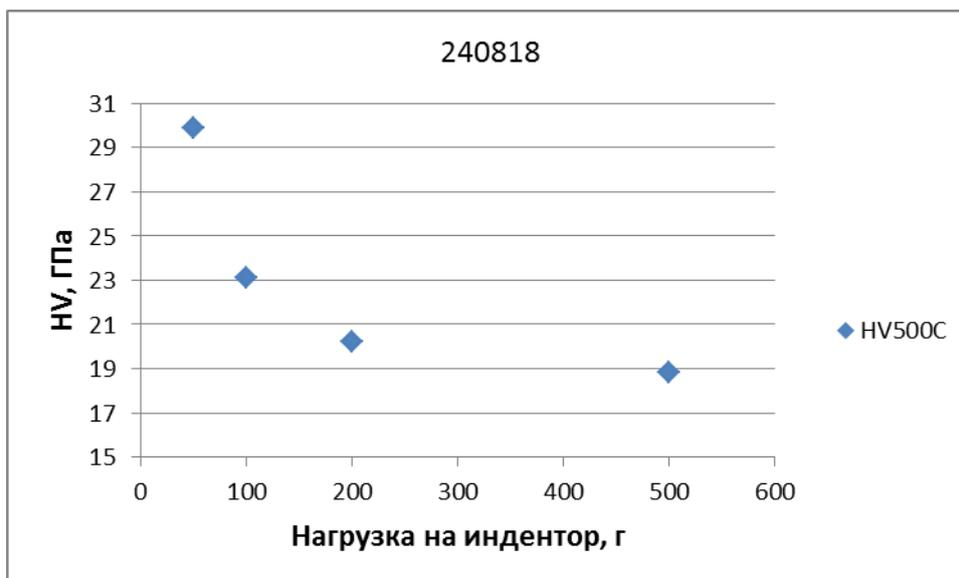
Рис. 28 Результаты измерений микротвёрдости композиционного покрытия на основе диборида титана и гафния (образец №240818) после отжига при температуре 500°C.
