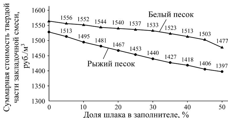
Рис. 2. Суммарная стоимость твердой части (портландцемент, песок, шлак) 1 м³ закладочной смеси в зависимости от доли шлака в заполнителе
