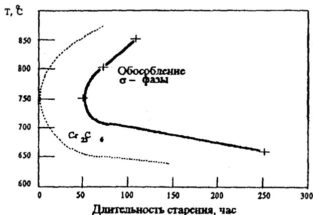
Рис. 1. Кинетические кривые начала образования карбида Cr_{23}C_6 и \sigma -фазы FeCr в стали марки 06X18H9T.
