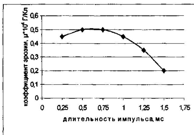
Рис. 1. Зависимость коэффициента эрозии графита от длительности импульса разряда.
