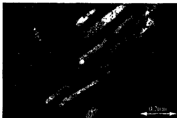
Рис. 5. Темнопольное изображение в рефлексе (0002) вытянутых субзерен в гафнии, деформированном на 60%, и микродифракция с этого места, ось зоны z = [2-1-10] .
