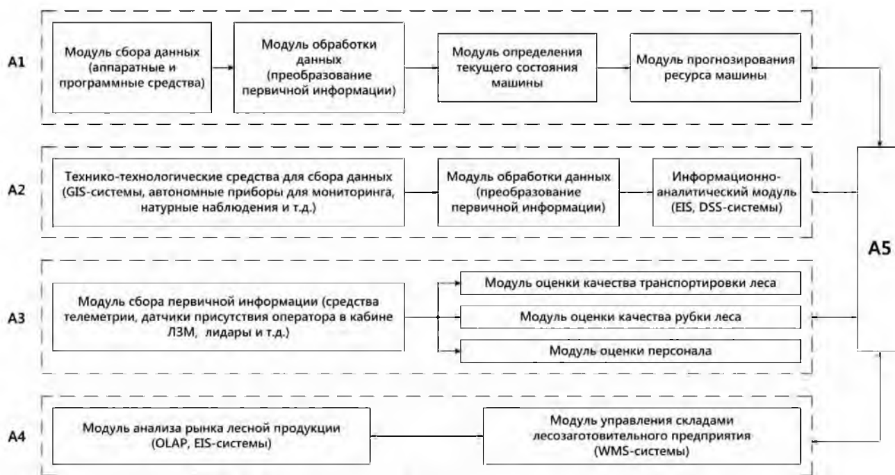
Рис. 1. Структура ИСУ лесозаготовками в рамках концепции «Индустрия 4.0» Fig. 1. Harvesting MIS structure within the frameworks of the «Industry 4.0» conception
