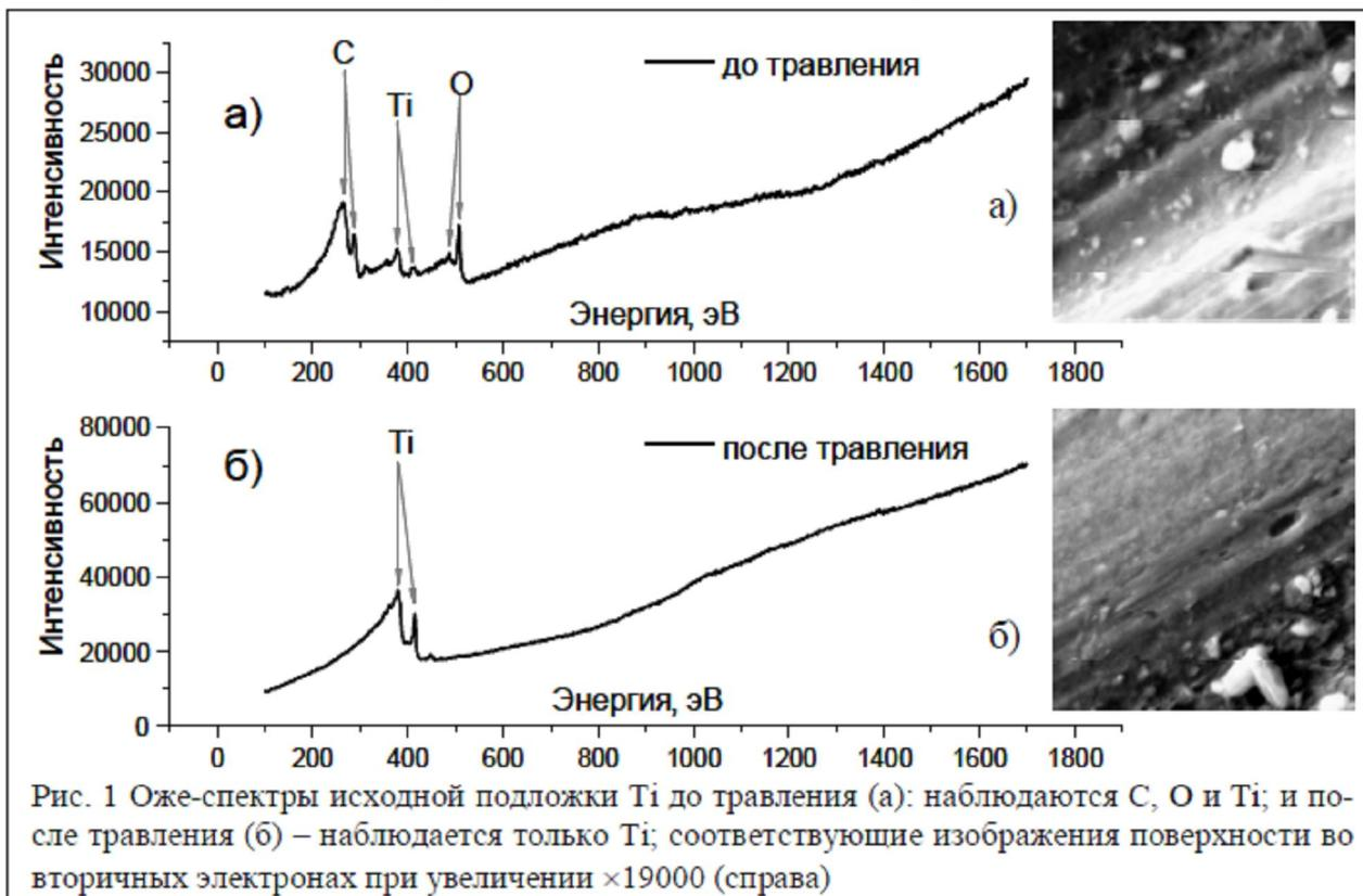
Рис. 1 Оже-спектры исходной подложки Ti до травления (а): наблюдаются C, O и Ti; и после травления (б) – наблюдается только Ti; соответствующие изображения поверхности во вторичных электронах при увеличении  $\times 19000$  (справа)
