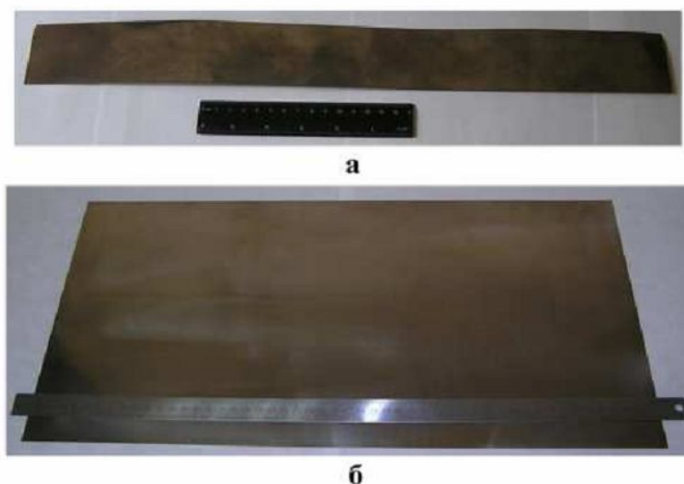
Рис. 3. Фотографии ленты и листа титана VT1-0 (а – 50x500x0.3, б – 250x500x0.3).
