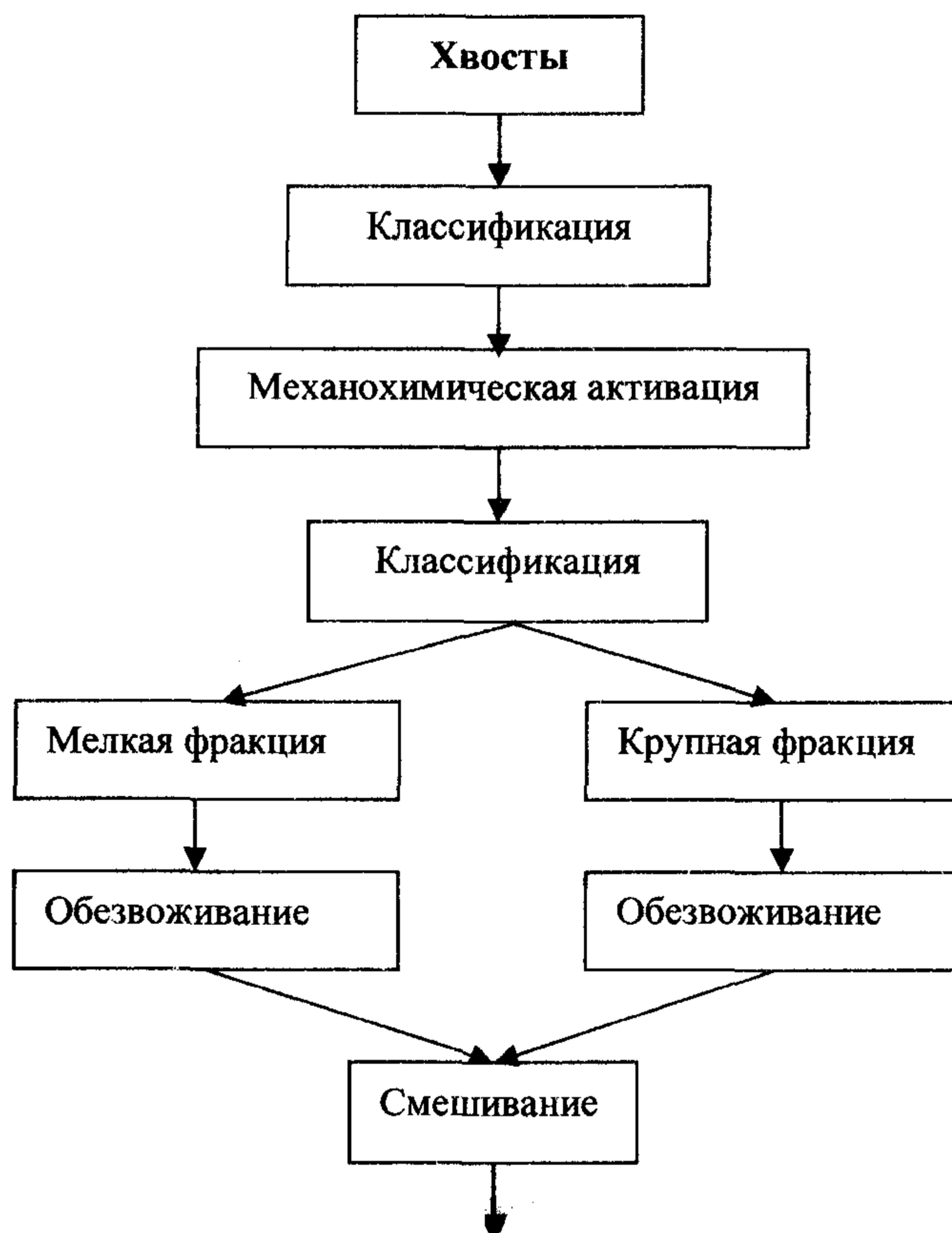
Рис. 6. Схема приготовления твердеющей смеси на основе хвостов обогащения
