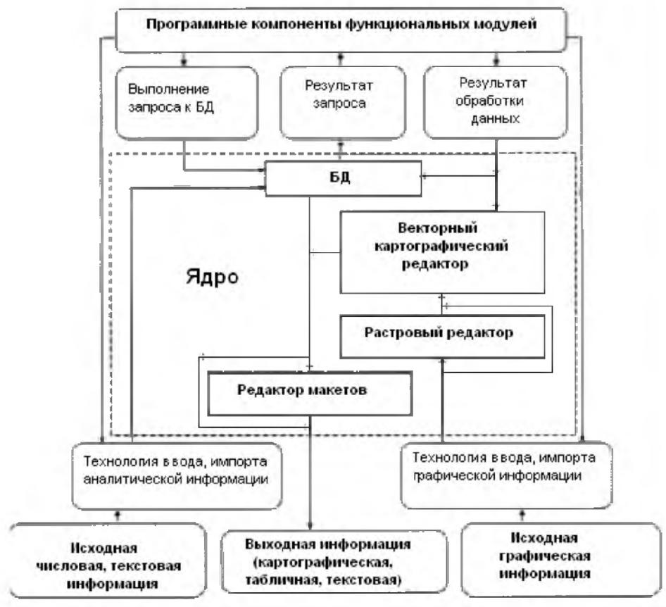
Рис. 2. Структурная и функциональная схема ГИС ГЕОМИКС
