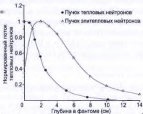
Рис. 7. Сравнение распределения потока тепловых и эпитепловых нейтронов по глубине в фантоме.
