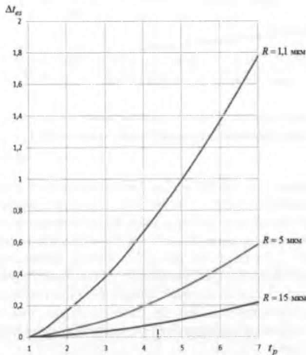
Рис. 1. Кривые зависимости скачка  $\Delta t_{es}$  обезразмеренной температуры воздуха  $t_e$  от обезразмеренной температуры поверхности частиц  $t_p$  при  $R = 1,1 \mu\text{м}$ ;  $5 \mu\text{м}$ ;  $15 \mu\text{м}$ .
