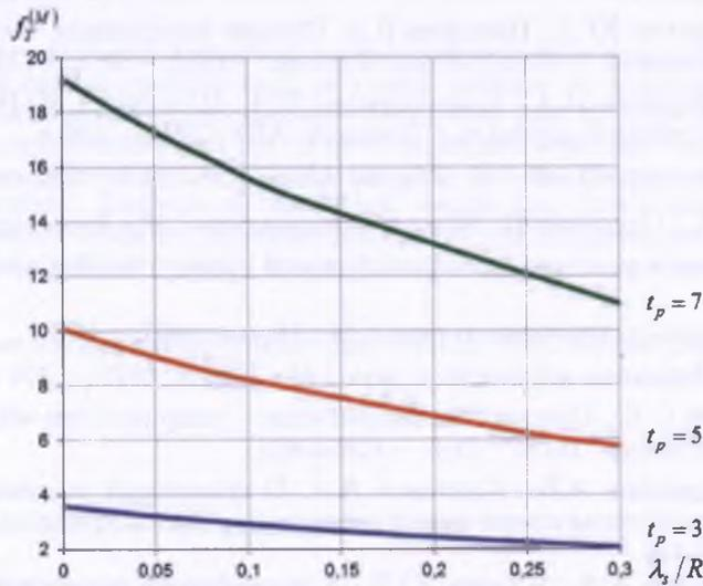
Рис. 3. Кривые зависимостей отношения  $f_T^{(M)} = Q_T^{(M)} / 4\pi R k_{e\infty} T_{e\infty}$  от числа Кнудсена при  $t_p = 3; 5; 7$ .
