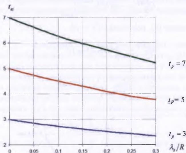
Рис. 2. Кривые зависимостей интерполированной температуры  $t_{es}$  от числа Кнудсена  $Kn = \lambda_s/R$  частиц при  $t_p = 3; 5; 7$ .
