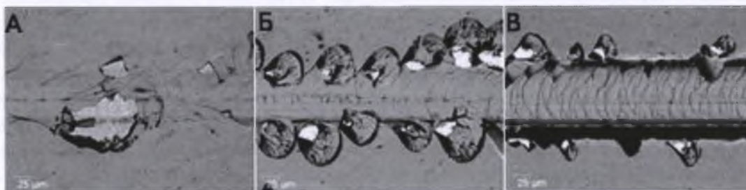
Рис. 7. Фотографии поверхности композиционных покрытий Fe_x(Al_2O_3)_{100-x} , нанесенных на металлические подложки и подвергнутых механическому воздействию сферическим контртелом: а) Fe_{50}(Al_2O_3)_{50} , нагрузка 4,8 Н, б) Fe_{60}(Al_2O_3)_{40} , нагрузка 6,5 Н, в) Fe_{78}(Al_2O_3)_{22} , нагрузка 14,5 Н.
