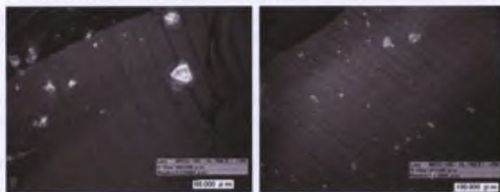
Рис. 6. Микроступеньки на поверхности разрушения сколом для образцов, разрушенных при энергии удара: а) 6.67, б) 17.7 кг·м 2 /с 2 .
