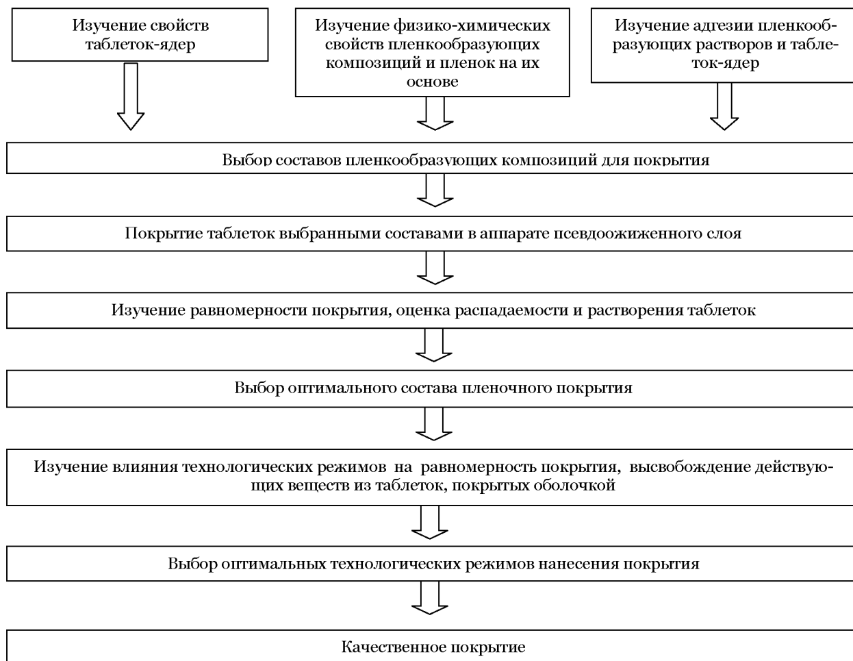
Рис. 1. Алгоритм разработки пленочного покрытия
