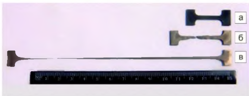
Рис. 3. Фотографии образцов деформированных при 1000°С: (а) а недеформированный образец; (б) литой образец ( \delta=77\% ); и (в) кованный образец ( \delta=864\% ). \dot{\epsilon} = 10^{-3} \text{ с}^{-1}
