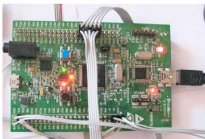
Рис. 2. Прототип блока управления связью между БС
