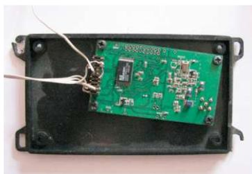
Рис. 4. GPS - приемник с активной антенной
