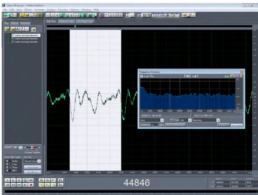
Рис. 5 Спектр фонемы звука «а» в программе Adobe Audition 3.0 для размера окна БПФ 128 отсчетов
