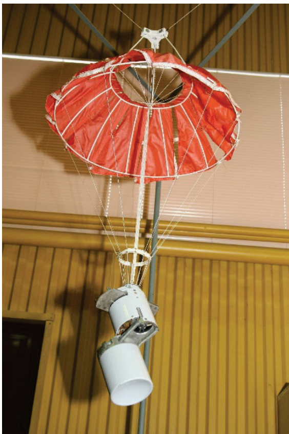
3 – макет самоприцеливающегося боевого элемента для снаряжения головных частей РС РСЗО “Град”.
