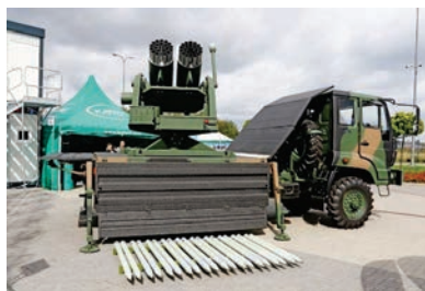
9 – вариант опытной БМ для пуска НАР. Алесин А. Реактивные системы залпового огня: мелодия для «Флейты». [Электронный ресурс]. Дата обновления: 06.12.2019 г. // URL: https://www.belrynok.by/2019/12/06/reaktivnye-sistemy-zalpovogo-ognya-melodiya-dlya-fleity/ (дата обращения: 11.01.2020 г.)
