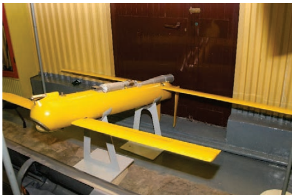
4 – макет опытного беспилотного летательного аппарата для снаряжения головной части опытного РС 9М534 в состав РСЗО “Смерч”.
