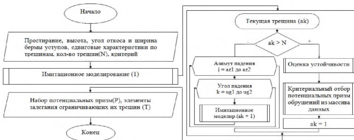
Рис. 1. Блок-схема рекурсивного алгоритма имитационного моделирования потенциальных призм обрушения
