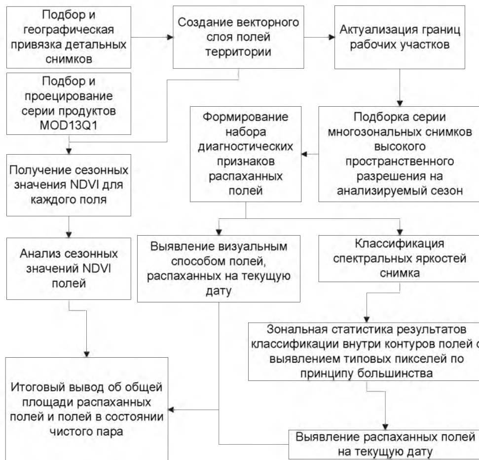
Рис. 3. Структурная схема методики выявления полей в состоянии чистого пара
