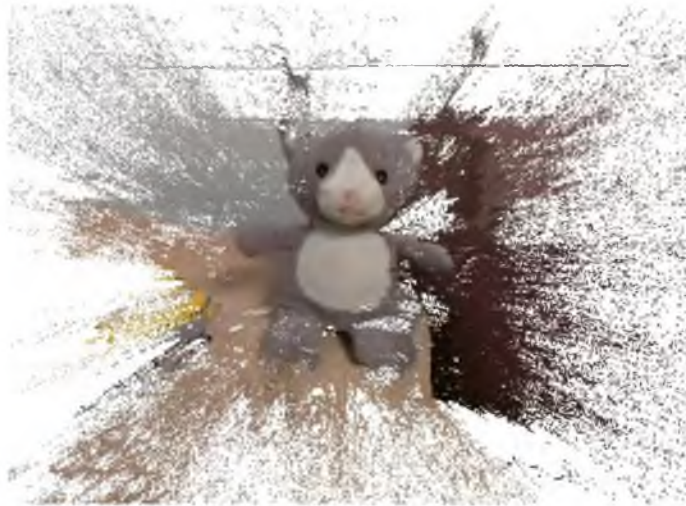
Рис. 10. Построение объемной модели на основе карты глубины Fig. 10. Building a volumetric model based on a depth map
