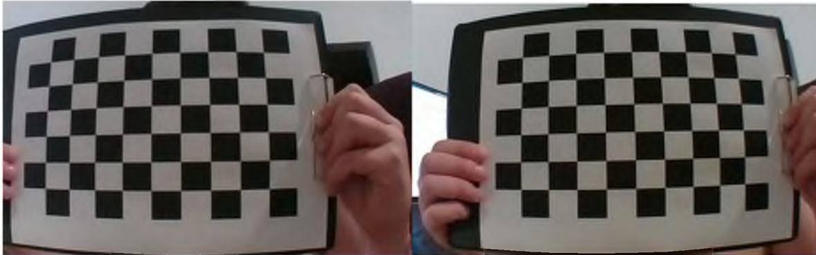
Рис. 6. Тестовый пример пары снимков для получения данных о глубине, с использованием калибровочной доски, для калибровки системы
