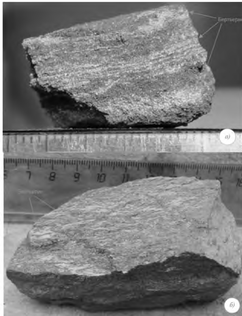
Рис. 4. Формы развития бертьерина в коре выветривания железистых кварцитов Большетроицкого месторождения: а) прослойки невыдержанной мощности в слабосцементированной мартитовой породе, скв. 6Р гл. 541.7 м и б) в цементирующей массе скальных железорудных пород, скв. 28Р гл. 485.1 м
