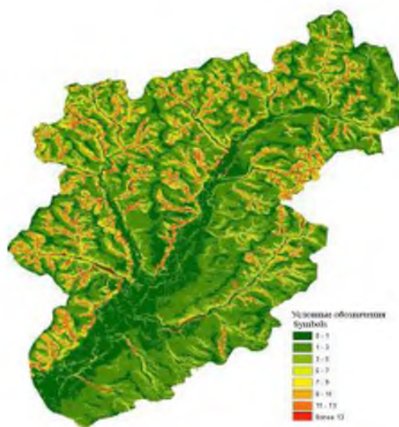
Рис. 4. Карта крутизны склонов (град.) в бассейн р. Ворсклица Fig. 4. The map of slope angles Vorsklitsa river basin (degree)
