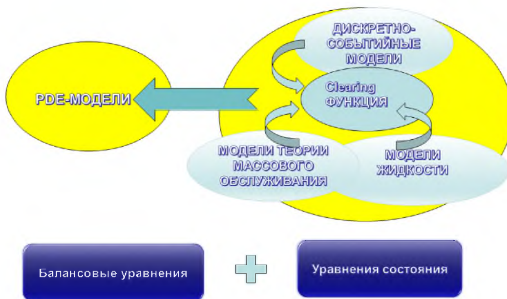
Рис. 6. Использование DES-,TQ- и Fluid-моделей в качестве уравнений состояния для замыкания балансовых уравнений PDE-моделей
