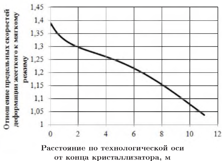
Рис. 6. Отношение предельных скоростей деформации жесткого режима к мягкому (1 – мягкий режим, 2 – режим средней интенсивности охлаждения, 3 – жесткий режим).
