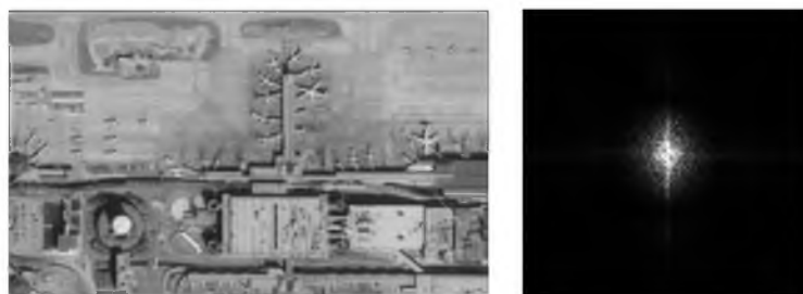
Рис. 2. Расфокусированный фрагмент исходного изображения и его Фурье-спектр
