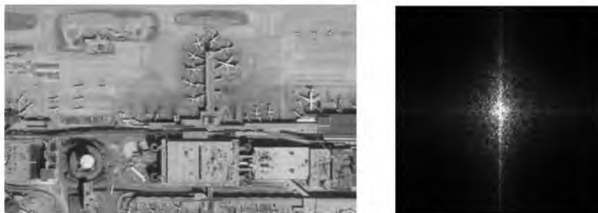
Рис. 1. Исходный фрагмент сформированного изображения высокого разрешения и его Фурье-спектр
