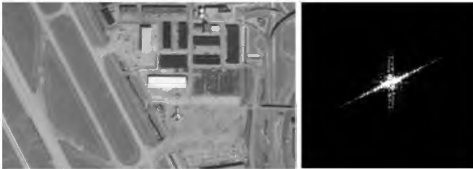
Рис. 5. Инспирированное с одним из трех субпиксельных сдвигов на две трети увеличенного пиксела изображение с измененными по апертуре пикселами в 3 раза (одно из трех изображений изображение) и его ПЧС Fig. 5. inspired by one of the three sub-pixel shifts in two-thirds of the increased pixel image with pixels changed by the aperture 3 times ( one of the three images of the image ) and its PSP
