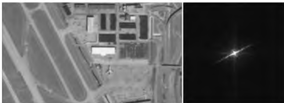
Рис. 7. Инспирированное изображение с удвоенной апертюрой пиксела и его ПЧС с выполненной сверткой с ФРТ, приведенной на правой части рисунка 2 Fig. 7. inspired image with twice the pixel aperture and PSP with the implementation of the convolution with the PSF shown in the right-hand side of Figure 2
