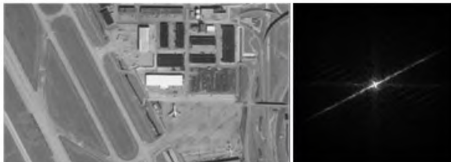
Рис. 11. Восстановленное изображение и его ПЧС при подавлении на инспирированных изображениях только перенесенной от исходного изображения остаточной ФРТ
