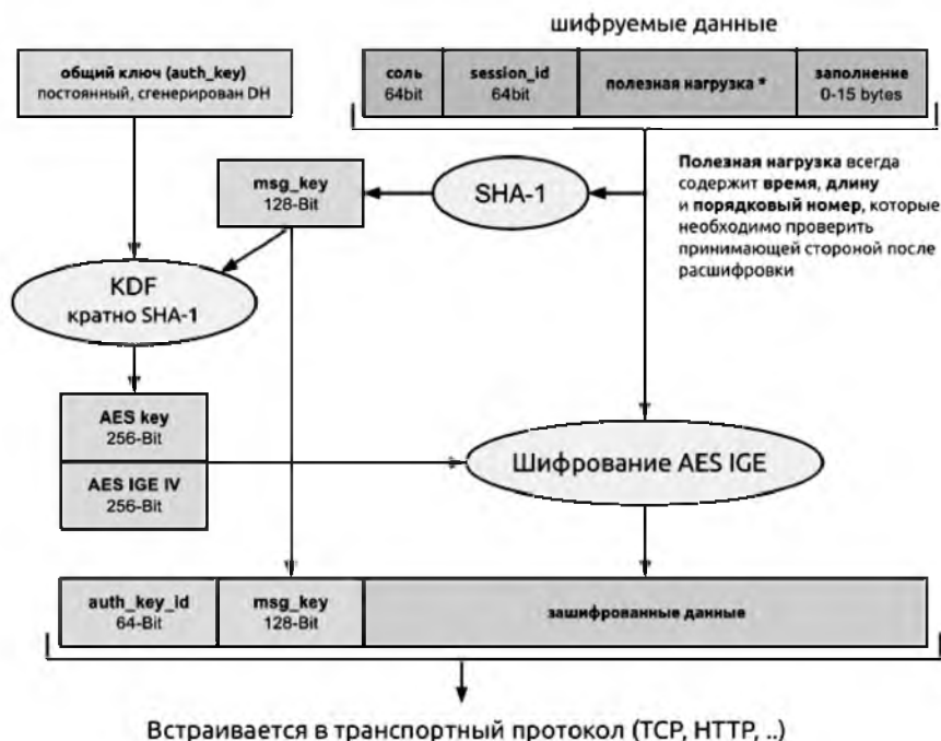
Рис. Схема шифрования протокола MTPProto Fig. Encryption scheme of the MTPProto protocol
