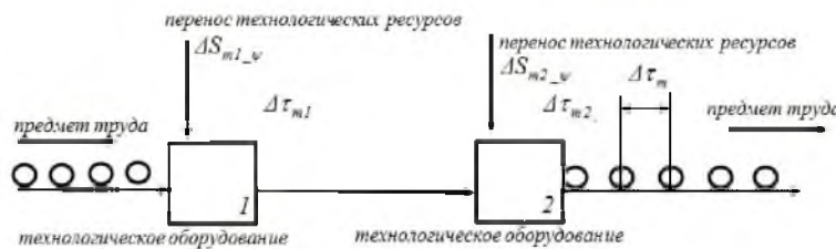
Рис. 4. Схема обобщенной единицы технологического оборудования Fig. 4. Scheme of generalized piece of equipment
