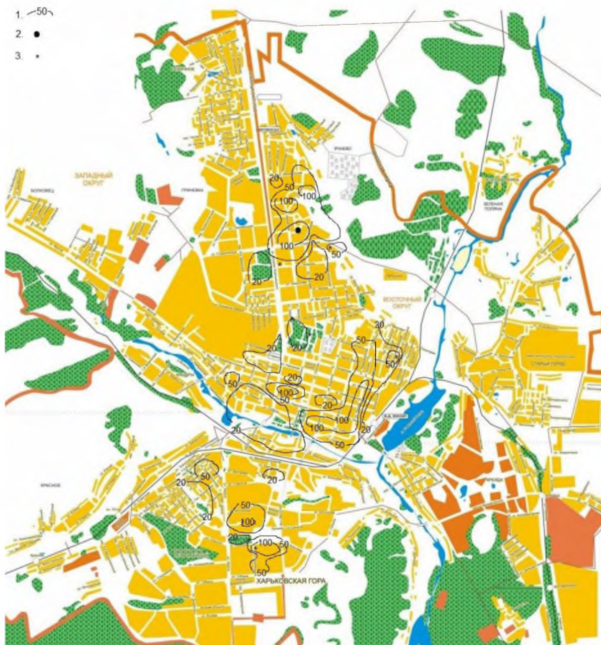
Рис. 2. Схематическая карта значений магнитной индукции в пределах территории г. Белгорода: 1. Изолинии и их оцифровка, нТл. 2. Аномалии по 3\delta пределу. 3. Аномалии по 2\delta пределу
