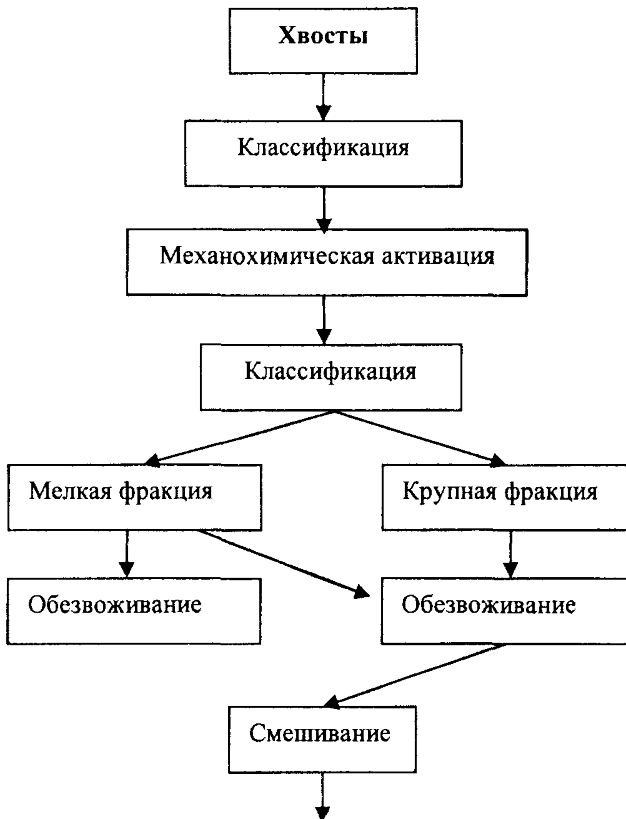
Рис. 3. Схема приготовления твердеющей смеси на основе хвостов обогащения
