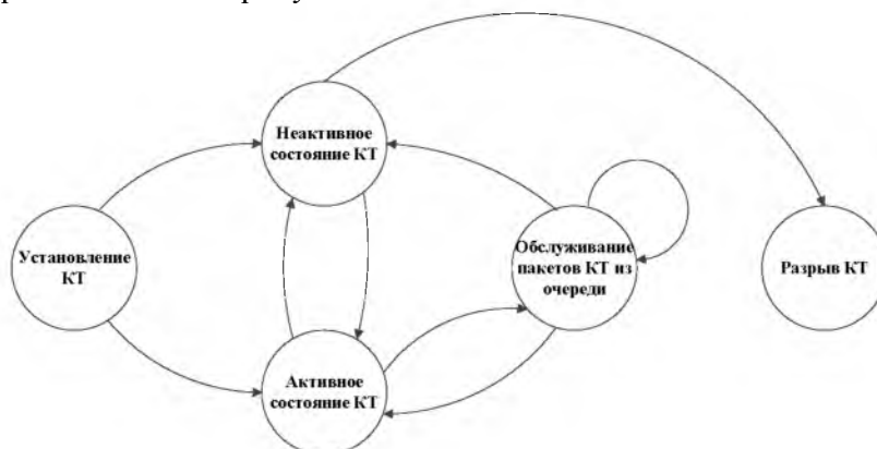
Рис. 3. Диаграмма возможных состояний криптотуннеля Fig. 3. The diagram of a cryptotunnel possible states
