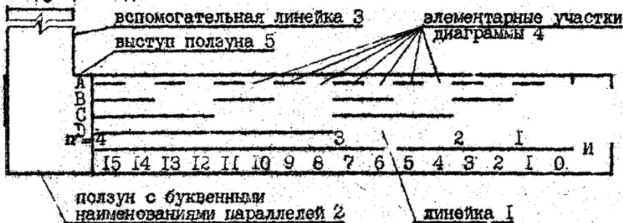
Линейка и ползун,двигающийся по полю линейки должны быть изготовлены из тонкого листа металла или пластмассы. Линейка I входит в отверстие охватывающего её ползуна 2.
