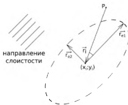
Рис. 4. Зона разрушения (обведена пунктиром) от скважины с координатами (x_i, y_i) в условиях слоистости породы
