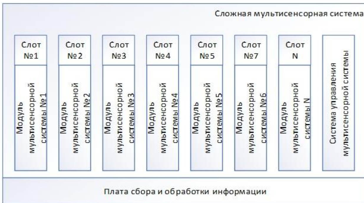
Рис. 2. Структурная схема сложной мультисенсорной системы Fig. 2. Block diagram of a complex multisensory system
