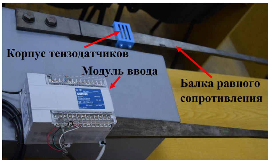
Рис. 1. Внешний вид разработанной лабораторной весоизмерительной системы Fig. 1. General view of the developed laboratory weight measurement system
