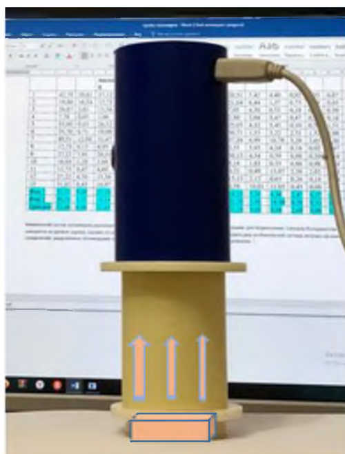
Рис. 1. Электронный «Нос-диагност» в рабочем состоянии. Образцы помещаются в ячейку детектирования для анализа Fig. 1. Electronic «Nose-diagnostic» in working condition. Samples are placed in the detection cell for analysis
