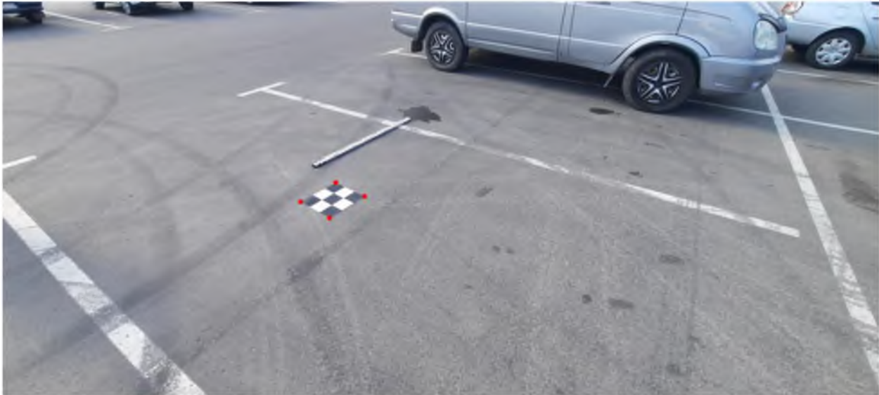
Рис. 2. Тестовое фото с расставленными точками углов объекта Fig. 2. Test photo with the points of the corners of the object
