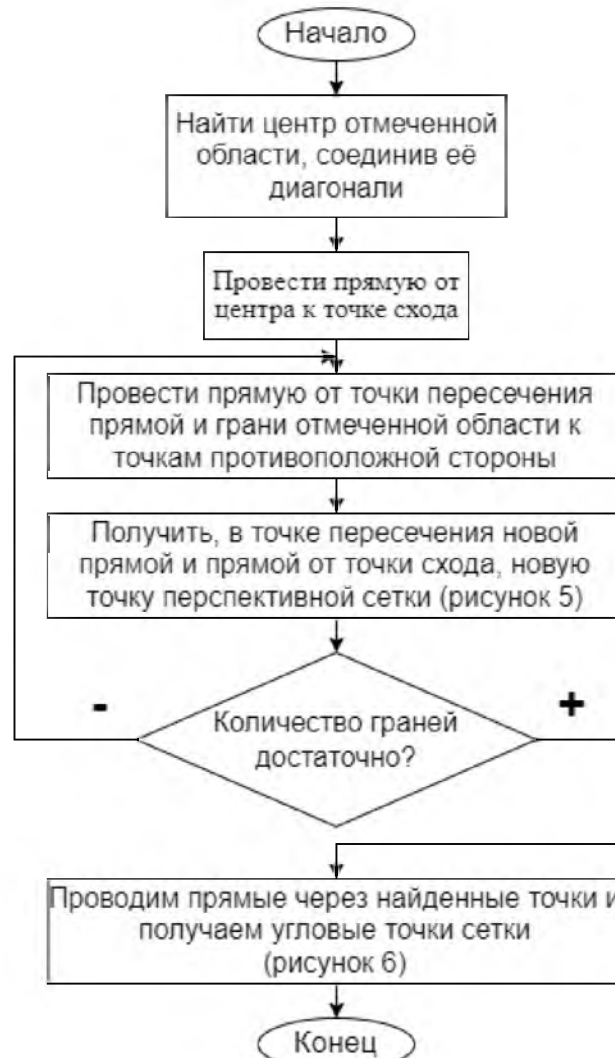
Рис. 4 Процесс расширения перспективной сетки Fig. 4. The process of expanding the perspective grid
