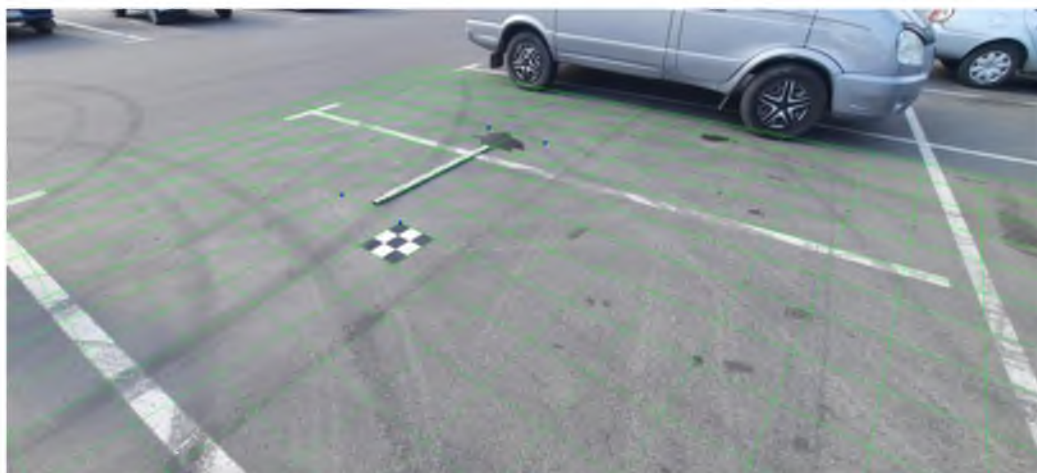
Рис. 8. Выделенная область перспективной сетки Fig. 8. The selected area of the perspective grid
