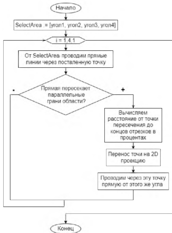
Рис. 15. Процесс переноса с перспективной сетки на 2D проекцию Fig. 15. The process of transferring from a perspective grid to a 2D projection
