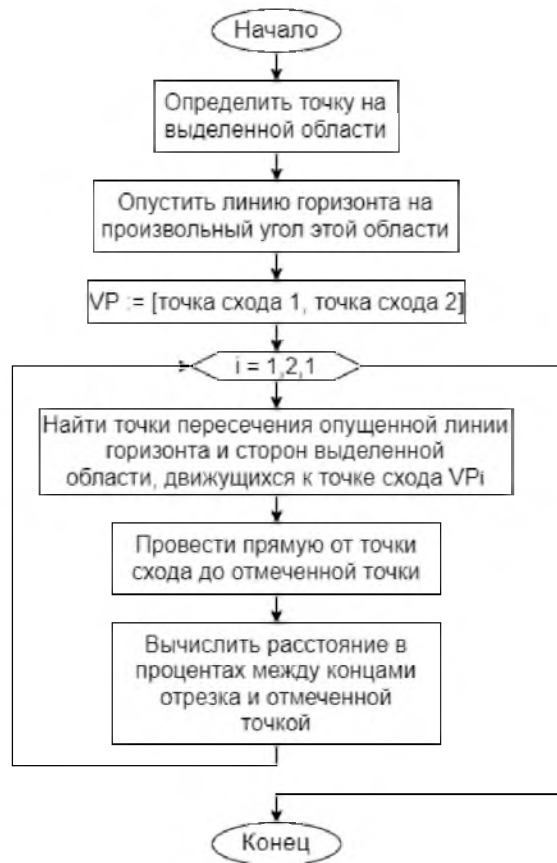
Рис. 10. Процесс переноса с перспективной сетки на 2D проекцию Fig. 10. The process of transferring from a perspective grid to a 2D projection
