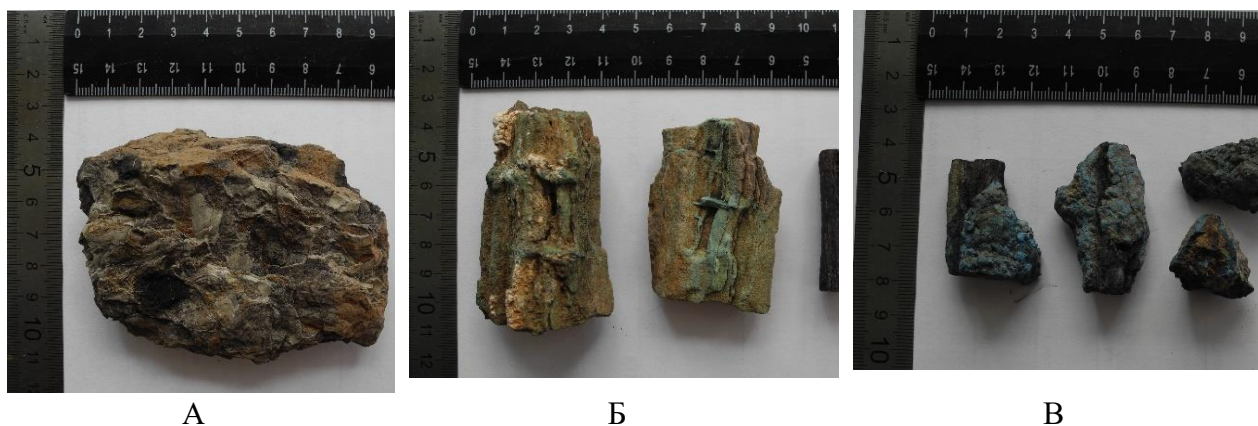
Рис. 2. Породы из Каргалинских рудников поздней бронзы: верхнепермские конгломераты (А), ископаемая древесина (Б), халькозин (В)
