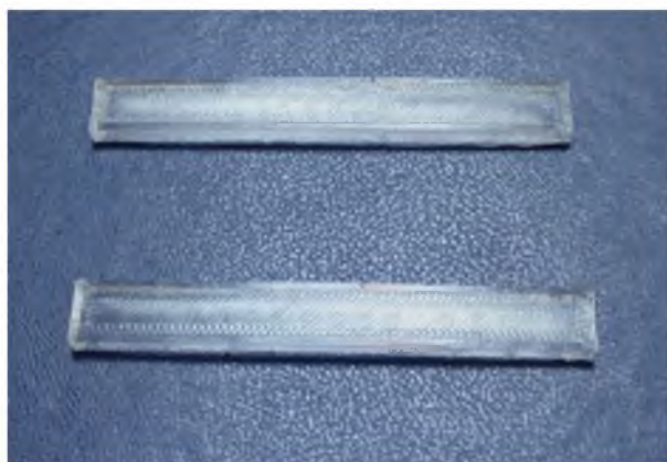
Рис. 2. Фотография образцов для проведения механических испытаний на трехточечный изгиб Fig. 2. Photograph of samples for mechanical testing under three-point bending
